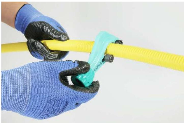
**Attention : Un serrage excessif peut engendrer une coupe irrégulière et des déformations sur le tuyau**
